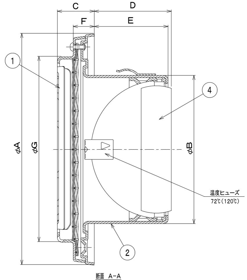
本体取付ビス: ST3. 5×30 十字穴付タッピンねじ SUS305製(3ヶ所)
